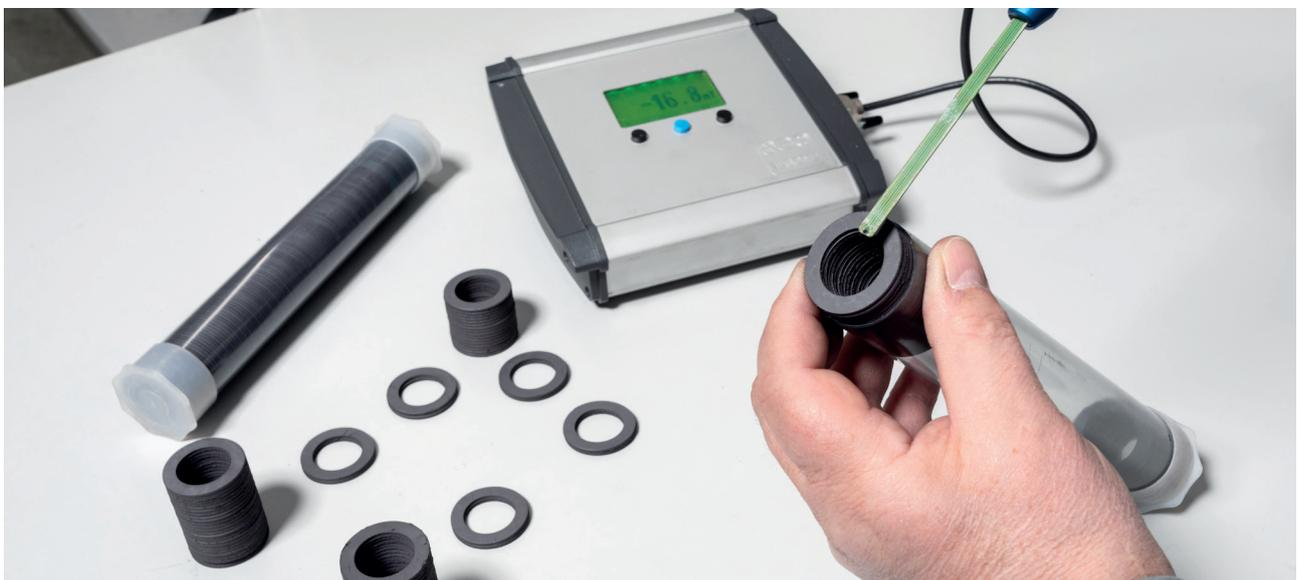
Bild 1: ELSOMA C10 Flusssichtmessgerät bei der Wareneingangsprüfung von magnetischen Polringen
