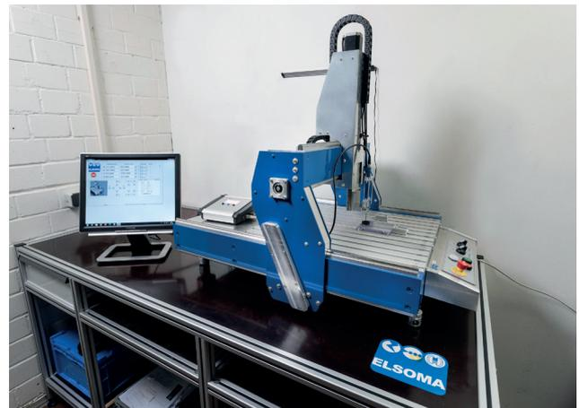
Bild 3: a) 3D magnetischer Mapper
