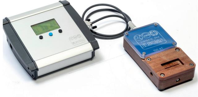
Bild 4: ELSOMA C10 Flusssichtmessgerät mit Messvorrichtung
