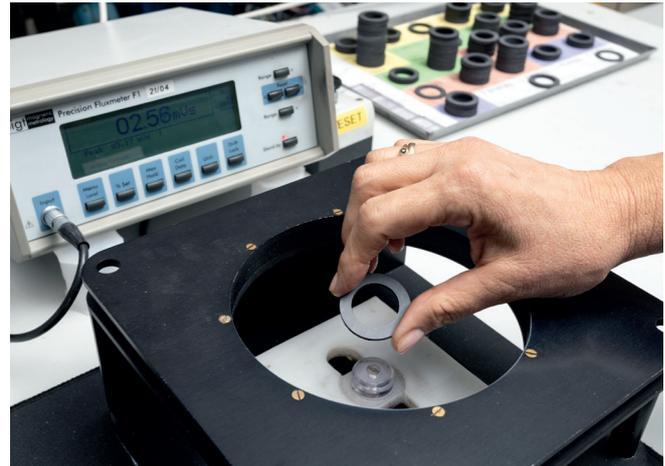
Bild 2: Fluxmeter mit Helmholtzspule
