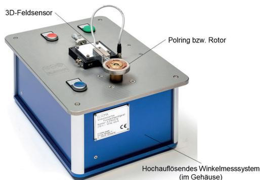
Bild 5: a) ELSOMA A05 winkelbasiertes Flussdichtemessgerät
