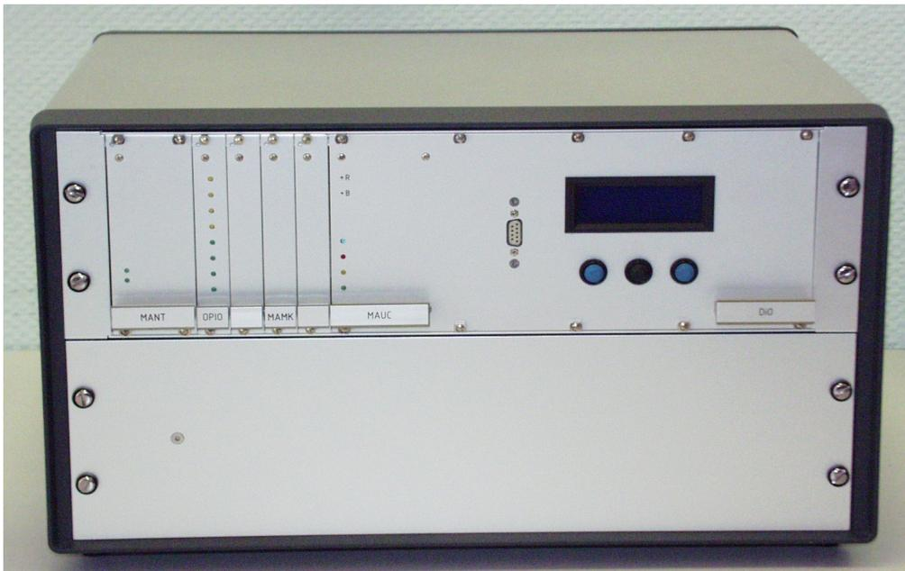
$\mu$ C Magnetisiergerät 230C4
