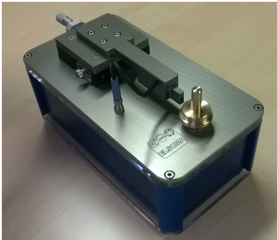
Winkelbasiertes Flussdichtemessgerät für radiale Messungen ELSOMA A03
